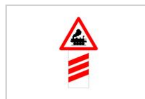
「警27」第一面無柵門鐵路平交...
